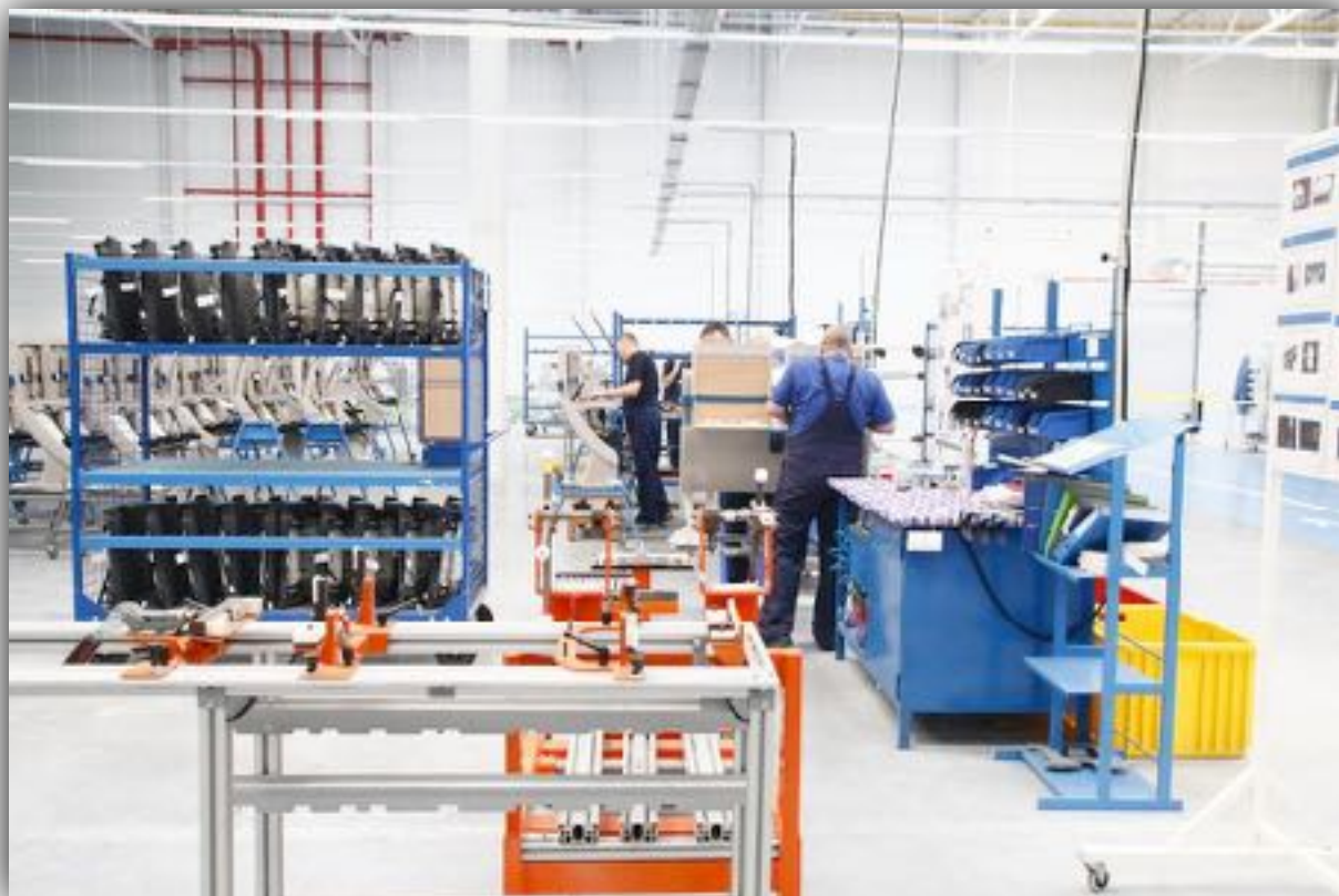
Rys. 4 Stanowisko montażu foteli
