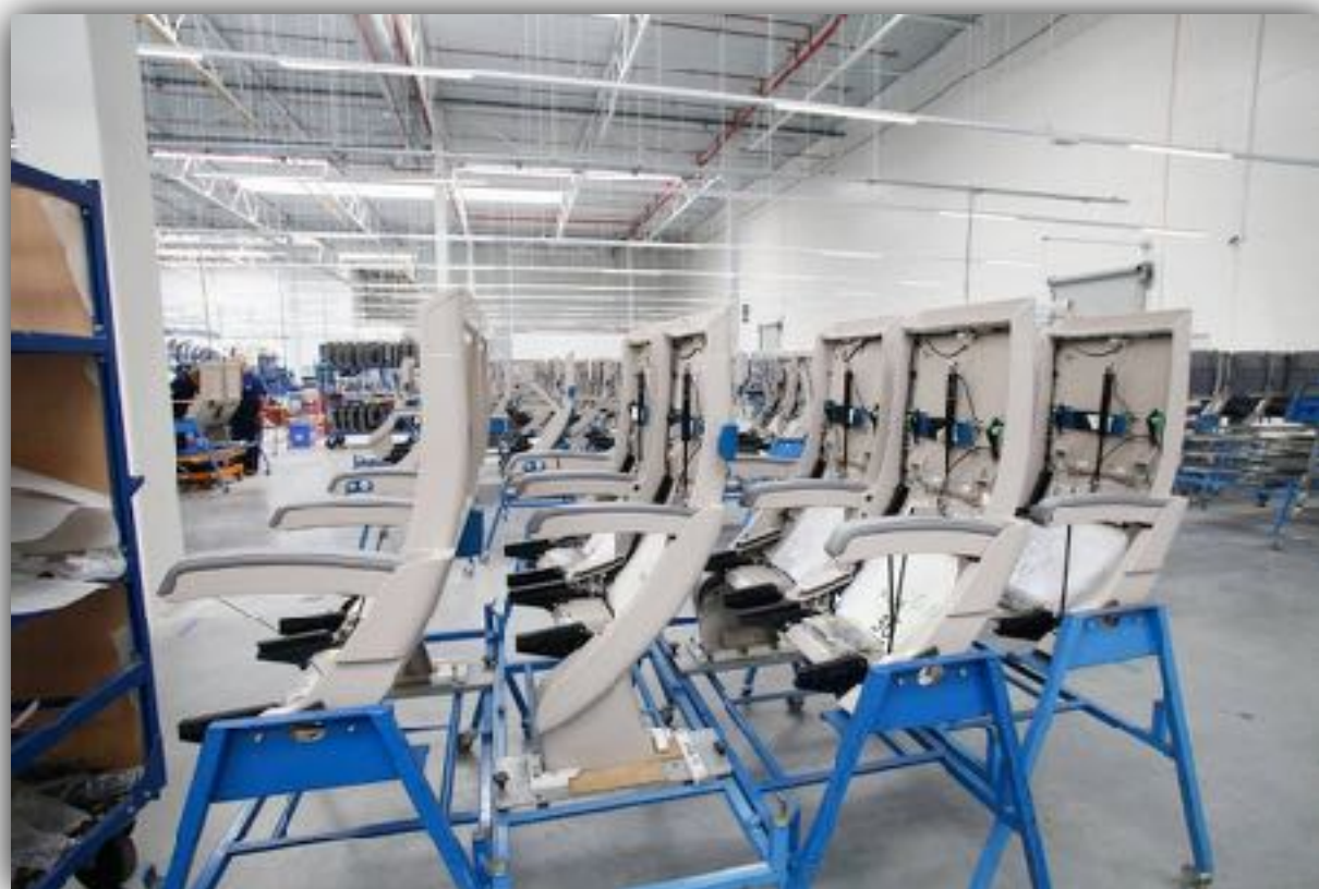
Rys. 3 Stanowisko montażu foteli
